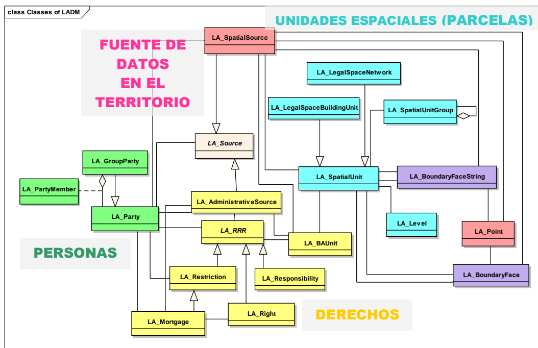
Diagrama UML en el que se muestran las principales clases del LADM. Fuente: Lemmen, et. al (2013).
