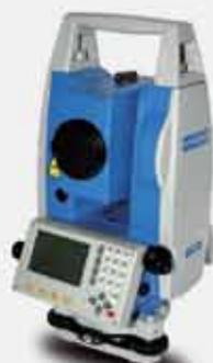
Transferencia de datos por SD/USB. Extensión de memoria con tarjeta SD. Bajada de datos via USB. Medición con prisma 5000 Mts. Medición sin prisma 350 Mts. Puntero láser visible. Disponible en 2" y 5". Doble display de LCD y teclado alfanumérico.
