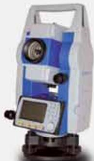
Origen Suiza. Medición con Prisma 7500 mts. Medición sin prisma 400 Mts. Disponible en 2" y 5". Sistema de compensador Cuadruple. Pantalla de LCD gráfica retroiluminable con teclado alfanumérico.
