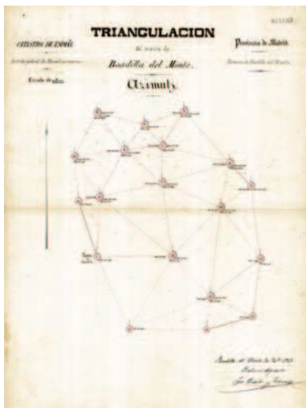
Figura 37 Mapa con los azimutes de los lados de los triángulos del Monte de Boadilla (A.T.IGN)
