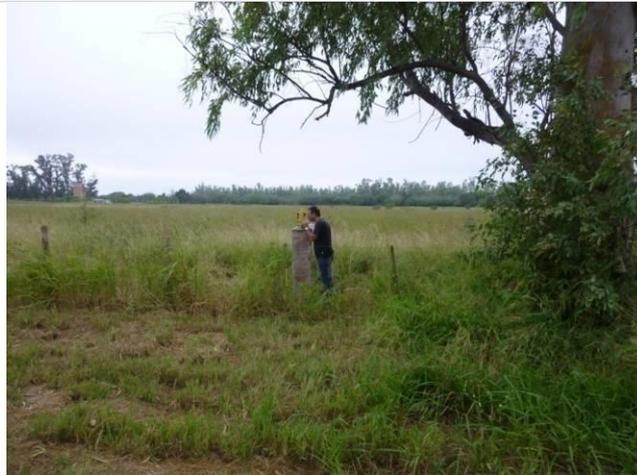
**Figura 7.- Nivelación Trigonométrica en extremo sobre pilar de observación**
