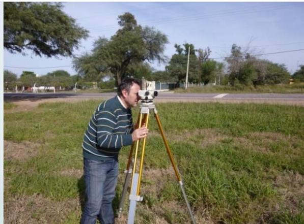
**Figuras 2 y 3.- Nivel óptico NIKON AX 25 y empleo en estación**
