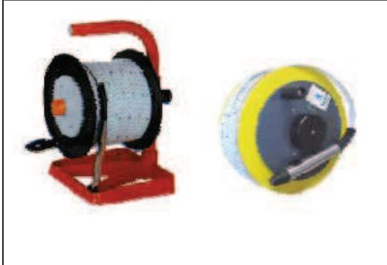
Sondas de contacto eléctricas KLL y KLL-Mini para el control de las estaciones mareográficas.
