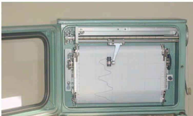
Figura 2: Mareógrafo DELTA de fabricación alemana instalado en las estaciones de la Red Mareográfica Nacional.
