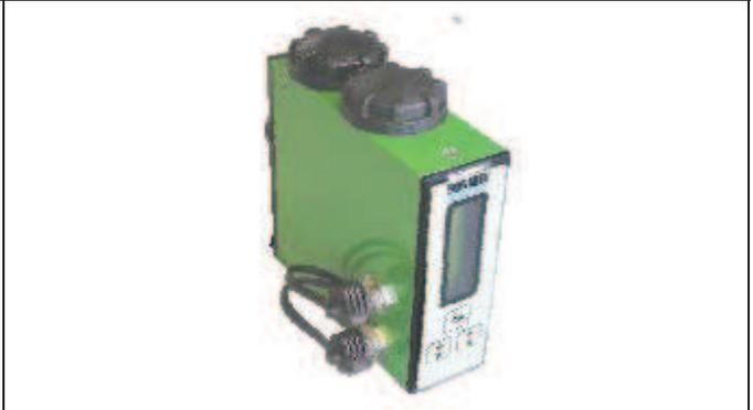
Datalogger DSR para la recepción de los datos medidos por el DST-22. Instalado en Mariel.
