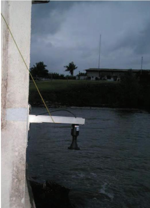
Sensor de radar instalado en la estación mareográfica Bufaderos.
