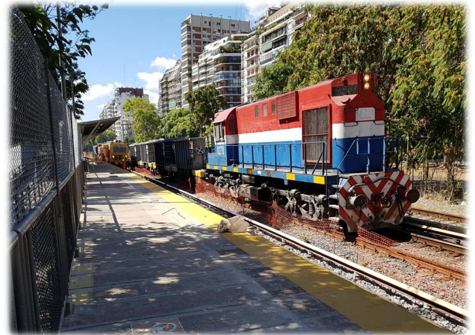
Tren de Trabajo Ferroviario: Locomotora + 3 Tolvas + 4 Vagones Playos
