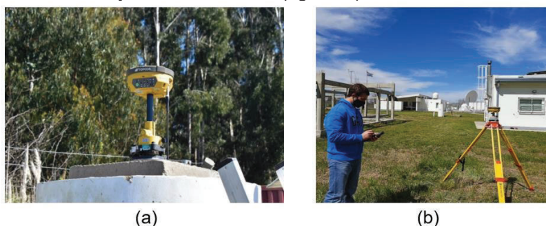
Figura 4: (a) Receptor base colocado sobre un punto de coordenadas conocidas (pilar). (b) Receptor rover sobre el punto 2 (trípode).
