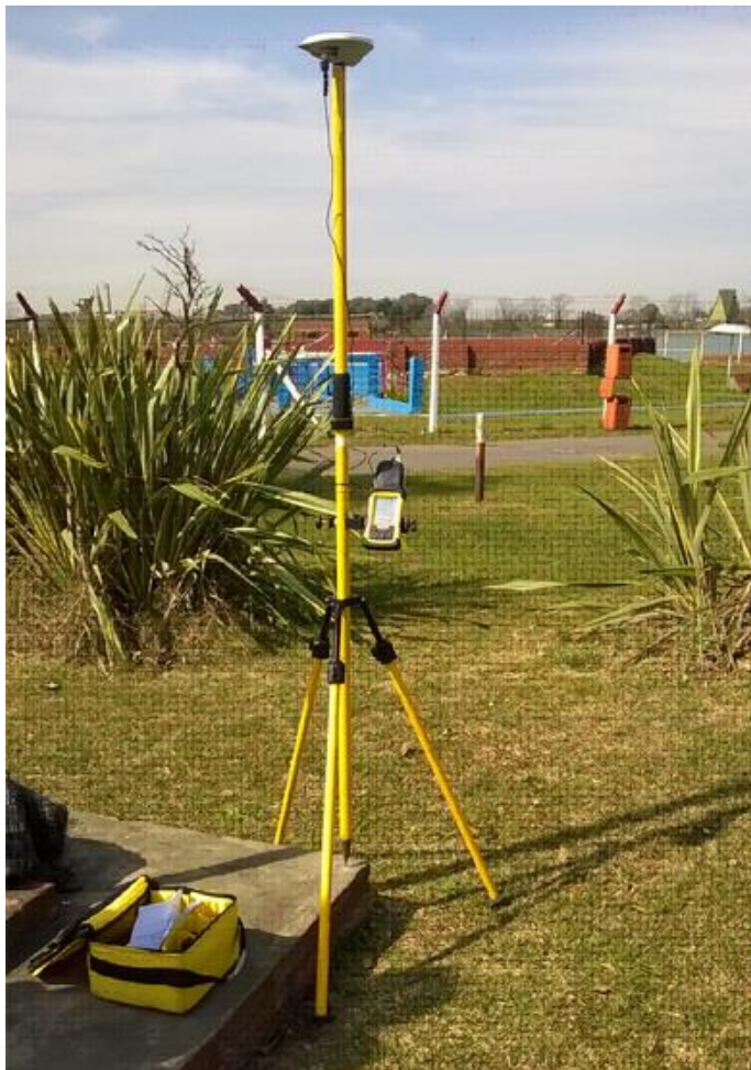
Imagen 8: punto base para medición bajo la modalidad stop and go
