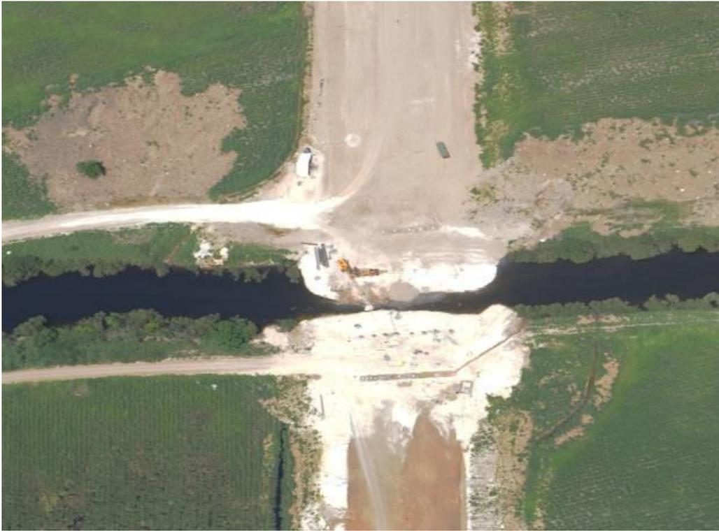
**Figura 3: Construcción de puente sobre un arroyo.**
