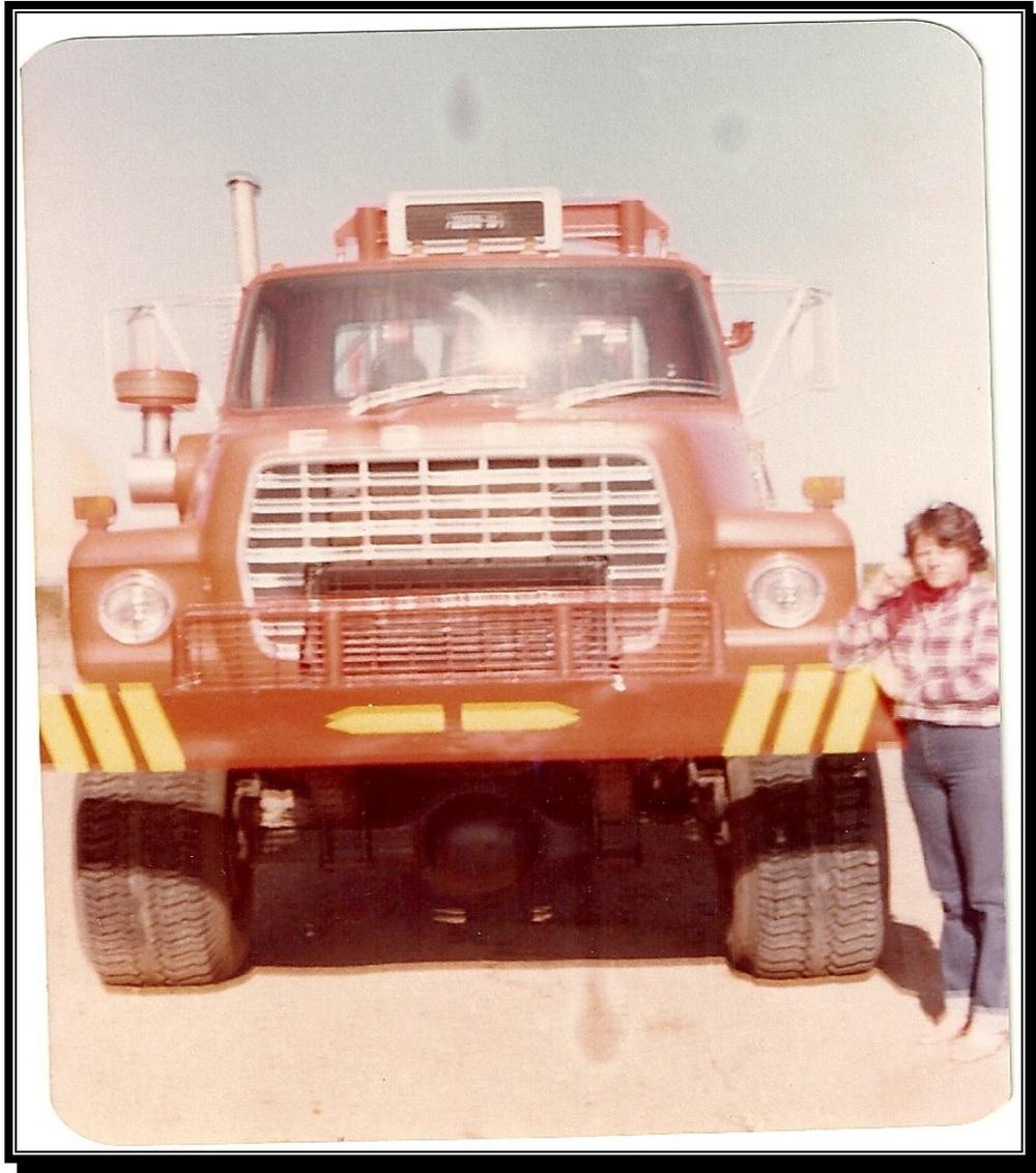
encima. Estos súper camiones con patonas de más de medio metro de ancho que impedían su hundimiento en la arena, provocaban la onda haciendo vibrar una plataforma de acero de metro por metro que asomaba de las entrañas mismas de su vientre y se apoyaba con fuerza en el terreno. Esto lo repetían en cada una de nuestras estacas. Y “guay” que hubiera algún problema en ellas.
