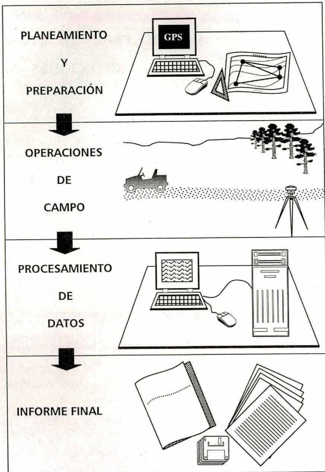
Fig. 6.1 Fases de una medición GPS
