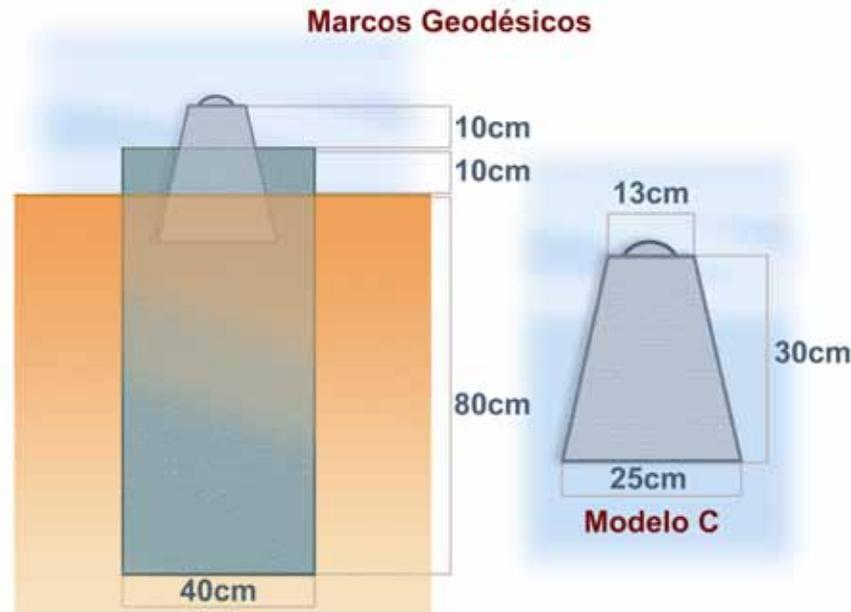
Figura 3.1– Modelo de marco geodésico em padrão definido pelo IBGE
