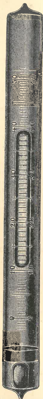
Fig. 2. — Se ilustra un nivel de cámara (el 0 se halla del lado del ocular del anteojo).
