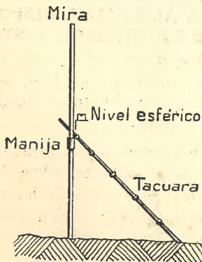
Fig. 16.— Mira con manija; su colocación vertical con ayuda de nivel esférico y tacuaras.
