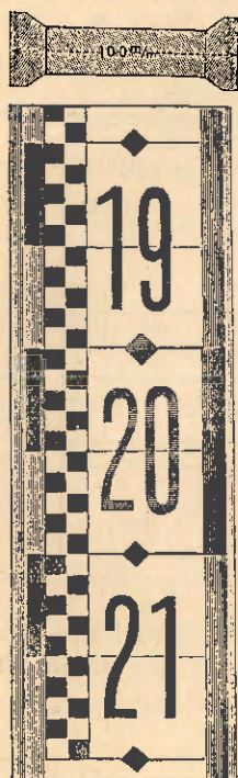
Fig. 14. Mira Suiza de Siegrist para nivelación y taquimetría (dibujada en escala 1:4), aspecto en anteojo inversor; modelo empleado en la Escuela Superior Técnica suiza de Zürich.
