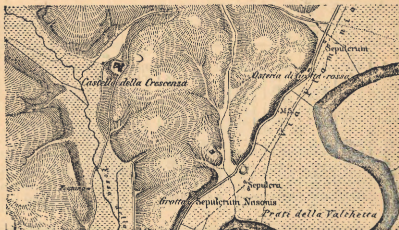
Fig. 42. Trozo del plano de Roma levantado a plancheta al 1:25 000 por Moltke en los años 1845 y 46 y dibujado según el sistema de trazos de Lehmann.
