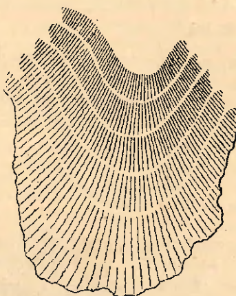
Fig. 31. Trazos de pendiente correspondiente a la forma de terreno representada en fig. 30
