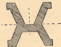
Fig. 3. Sección del Metro Prototipo Internacional, tamaño natural.
