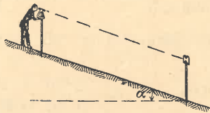
Fig. 8. Midiendo la inclinación de un trozo de pendiente uniforme.
