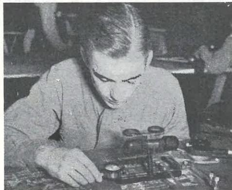
FIG. 160. — Con un buscador de cotas pueden trazarse curvas de nivel sobre un par de fotografías estereoscópicas.
