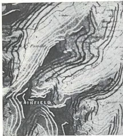
FIG. 101. — Las líneas de nivel iluminadas producen un efecto de escalonamiento del terreno.
