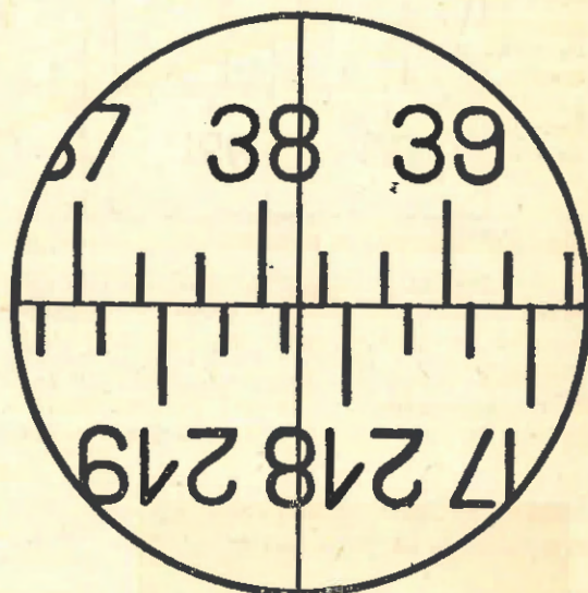
Fig. 27. — Imagen de las divisiones de círculo diametralmente opuestas vista en el campo visual de un anteojo de teodolito sencillo.
