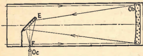
Fig. 67. — Esquema del telescopio reflector de Newton.
