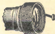
Fig. 5. — Luzbrera de iluminación , según O. FENNEL. Es un pequeño espejo montado delante de un anteojo, con ayuda del cual se proyecta luz dentro de aquél para iluminar el campo visual. Se le utiliza en trabajos de minería y túneles.
