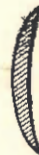
Fig. 3. Lente cóncavoconvexa r_1 y r_2 positivos, r_2 > r_1 ; o también: r_1 y r_2 negativos, r_1 > r_2
