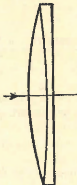
Fig. 32. — Se ilustra la forma de la lente objetiva acromática correspondiente a los valores numéricos del ejemplo.
