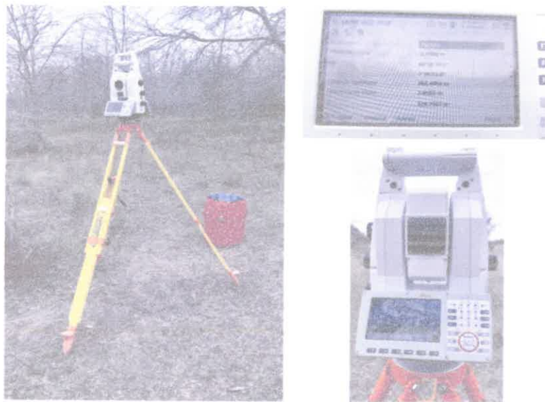
Figura 7.4: Imagen de la estación total Leica TS60 sobre el punto 1.
