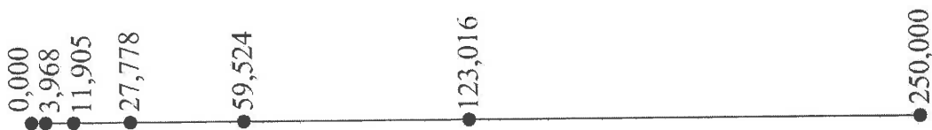
Figura 4.14: Diseño de base obtenido de acuerdo con el diseño alternativo propuesto por la norma ISO 17123-4:2012.
