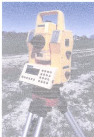
Figura 2.4: Estación total marca Geodimeter, modelo 600. A este equipo lo integra un teodolito digital, un distanciómetro electrónico y una computadora interna.
