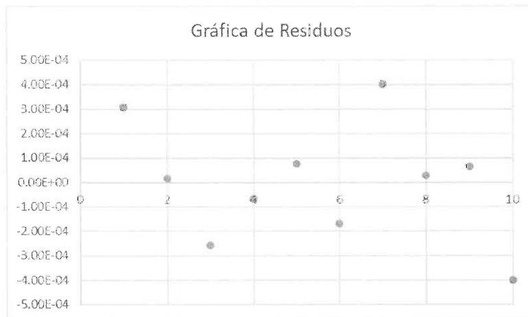
Figura 7.11: Gráfico de residuos dados por el ajuste de las distancias de acuerdo con la norma ISO 17123-4:2012.
