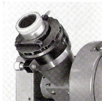
Fig. 25 Teodolito de micrómetro Wild T1 con prisma solar (espiga hacia arriba)
