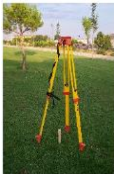
Tripode excesivamente cerrado
