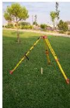
Tripode excesivamente abierto
