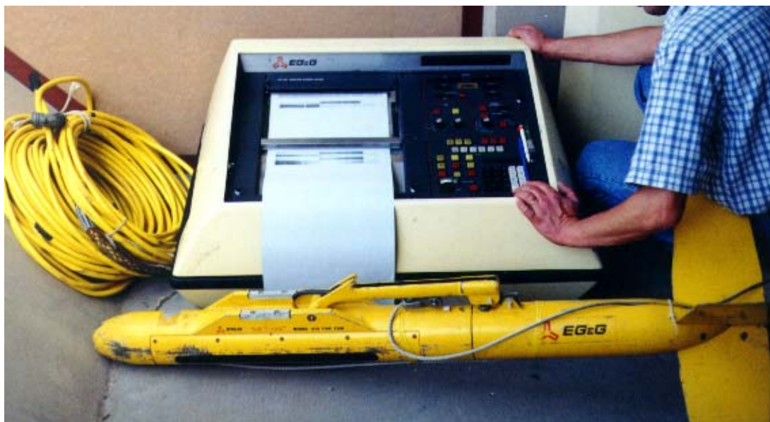
Figura 7.a - Sonar de barrido lateral. Componentes: registrador, "tow fish" con transductores y cable.
