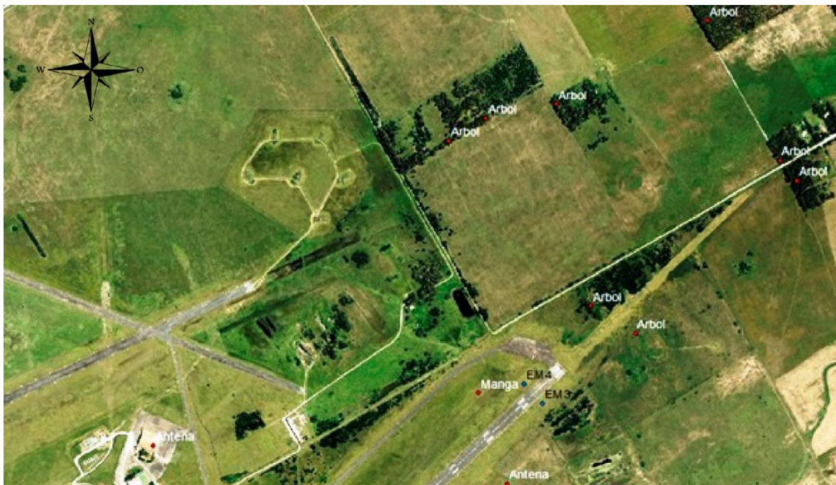
Ilustración 32: Puntos relevados con estación total desde la cabecera que da hacia el río de La Plata.
