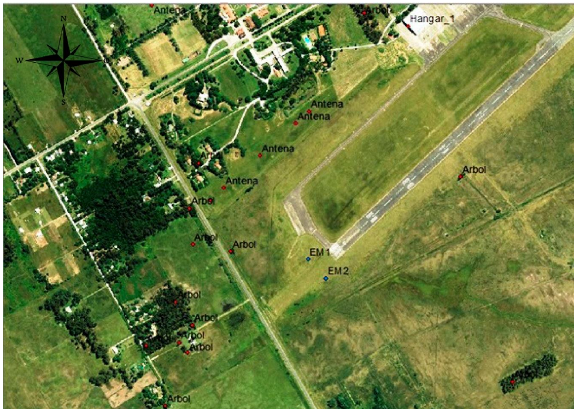
Ilustración 31: Puntos relevados con estación total desde la cabecera que da hacia Verónica.
