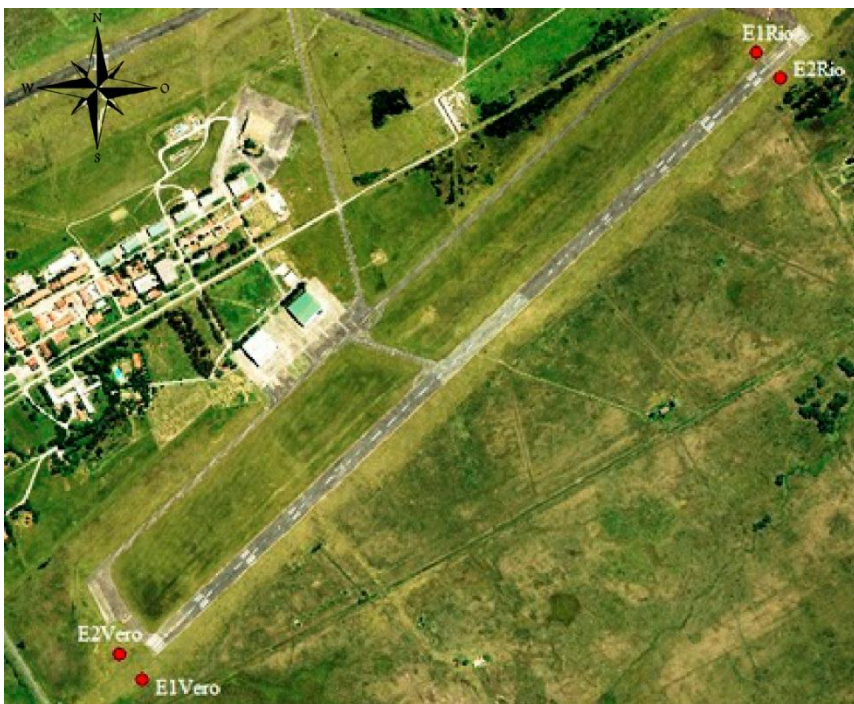
Ilustración 20: Se muestran los puntos de estación, para la ejecución del método base enfrentada.
