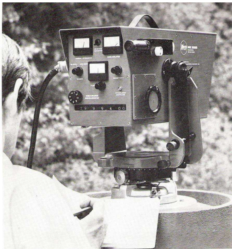
Fig. 1 El Mekometer ME 3000 montado sobre un pilar, en la medición de una base
