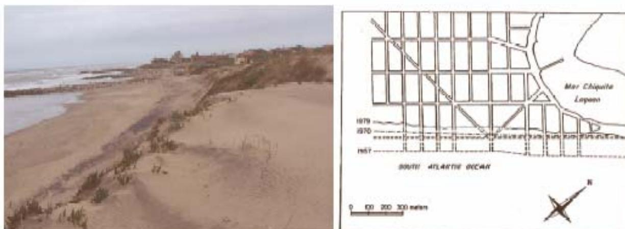
Figura 1. Izquierda: la costa de Mar Chiquita, al sur de la desembocadura de la laguna. Derecha: Retroceso de la línea de costa en el mismo sector, entre 1957 y 1979. El proceso ha sido atenuado mediante obras de defensa.
