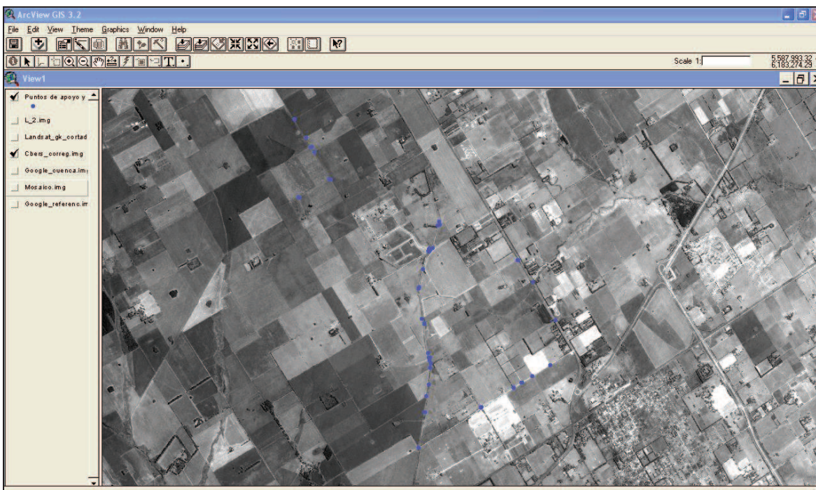
Figura 27. Pantalla de ArcView con Imagen CBERS 2B y puntos de apoyo y control
