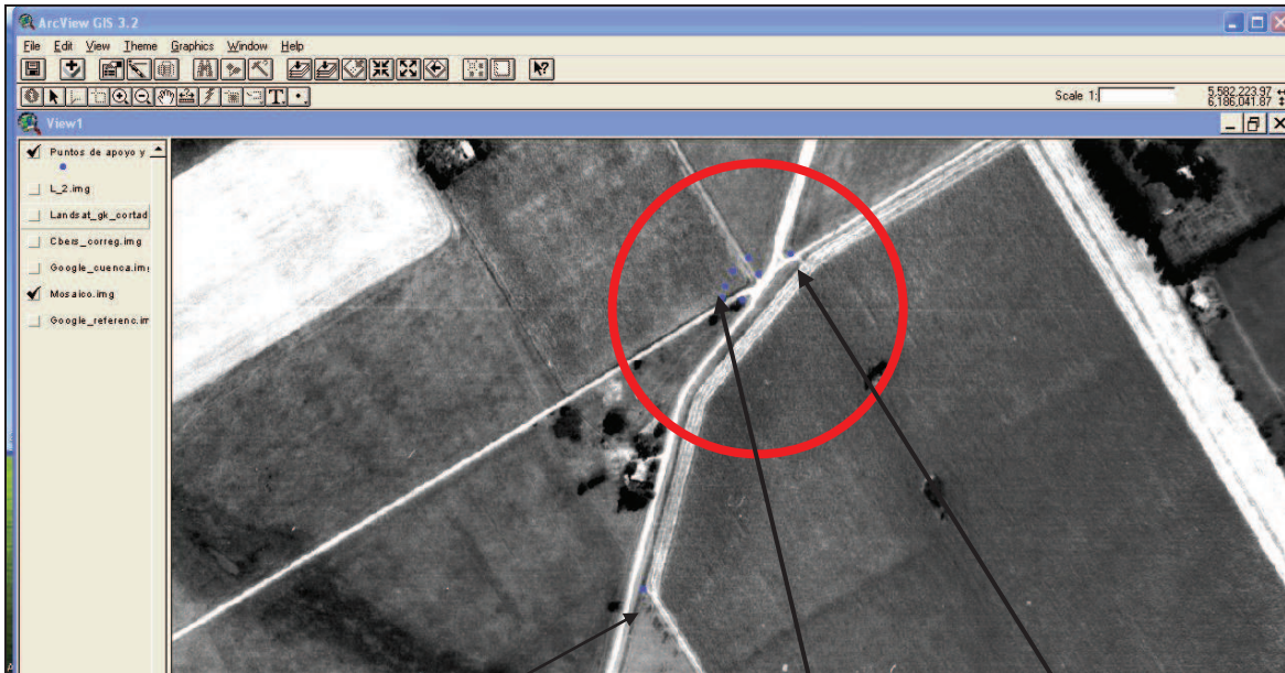
Figura 20. Pantalla de ArcView con Mosaico georreferenciado y puntos de apoyo y control
