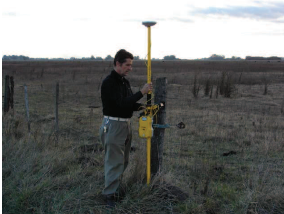
Foto 1. Midiendo los puntos de apoyo y control, con GPS de precisión.
