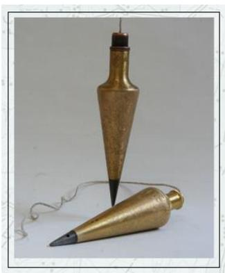
**Plomada.** Es una pesa metálica terminada en punta y suspendida por una cuerda. Sirve para definir la vertical que pasa por un punto.
