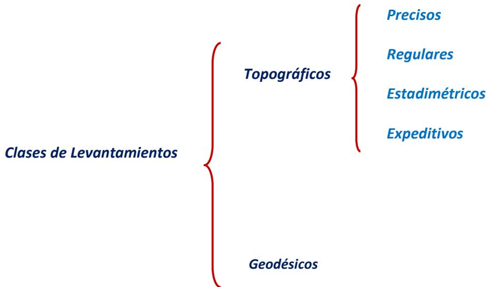
**Precisos.**- Se ejecutan por medio de equipo electrónico y métodos rigurosos de levantamiento y cálculo, para fijar límites y localizaciones exactas; control para grandes obras de infraestructura, trazo de complejos habitacionales o industriales, etc.
