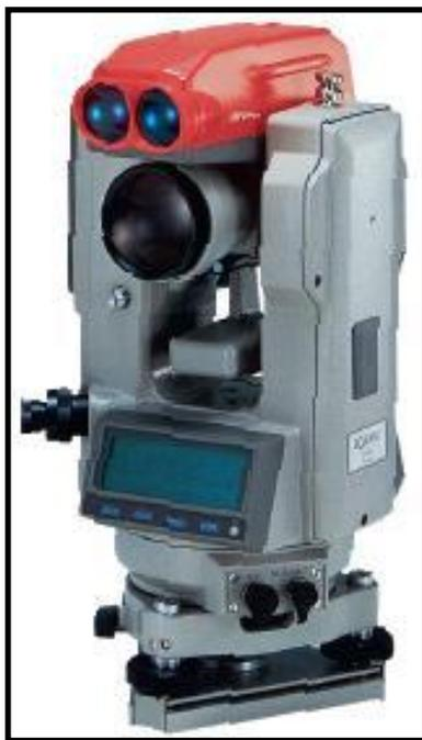
*Teodolito con Distanciómetro acoplado*
