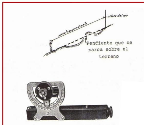
Una vez localizada la línea a pelo de tierra, como resulta muy quebrada, la poligonal del trazo preliminar se lleva localizando tangentes largas que compensen o unan la mayor parte de los puntos localizados.
