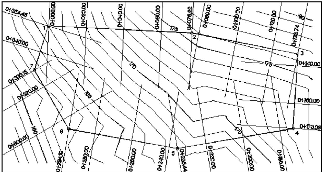
**Método de Secciones Transversales**
