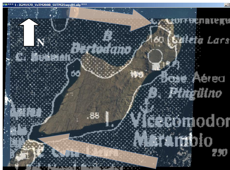
Figura 49. Superposición de carta IGN 1:500.000 (año 1970) con imagen Landsat ETM (año 2000)
