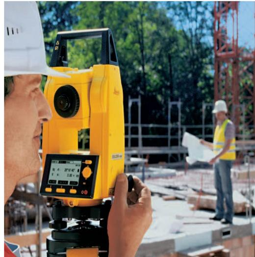
Sencillo Montaje en estación, la plomada láser y el auxiliar grafico de nivelación hacen muy fácil y cómodo el montaje en estación.
