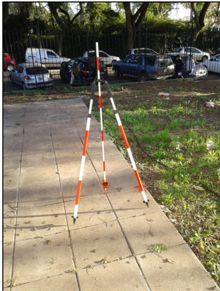
Fig. 3b- Reflector mini-prisma con bípode para medición de distancias precisas.
