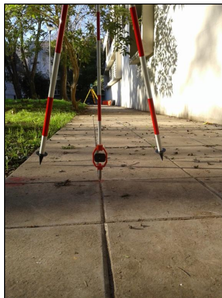
Fig. 3b- Reflector mini-prisma con bípode para medición de distancias precisas.
