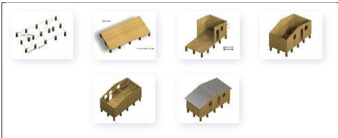
ONG Un Techo Para Mi País - Proceso del armado de la vivienda -
