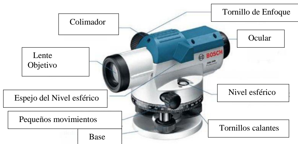
Figura 1: Componentes principales de un nivel automático.
