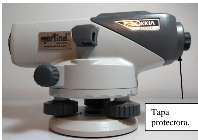
Figura 12-a: Nivel Automático. Tapa protectora de tornillo para corrección del retículo.
