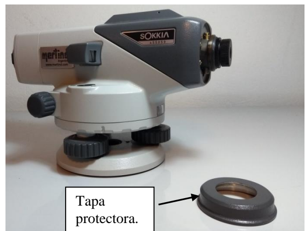
Figura 12-a: Nivel Automático. Tapa protectora de tornillo para corrección del retículo.
