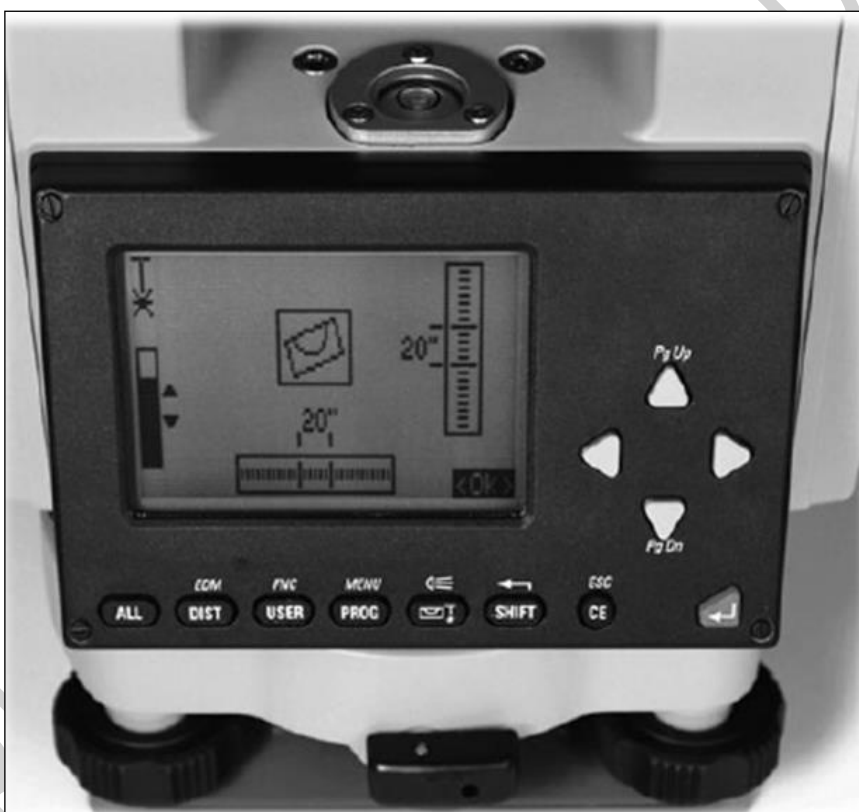
Estación total Leica TPS 300
