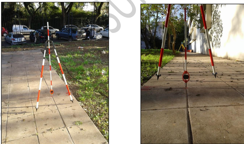
Fig. 3b- Reflector mini-prisma con bípode para medición de distancias precisas.
