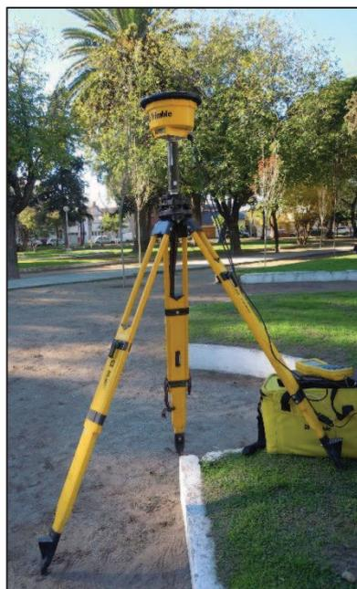
Figura 17: Medición con GPS TRIMBLE 4800 sobre PE
