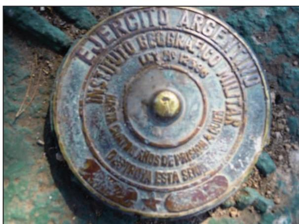
Figura 15: Punto Fijo de la Red de Alta Precisión
