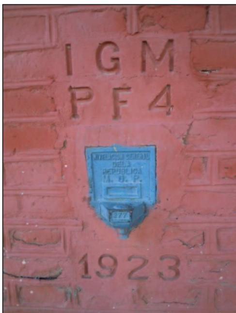
Figura 16: Ménsula de la Red de Alta Precisión sobre muro.
