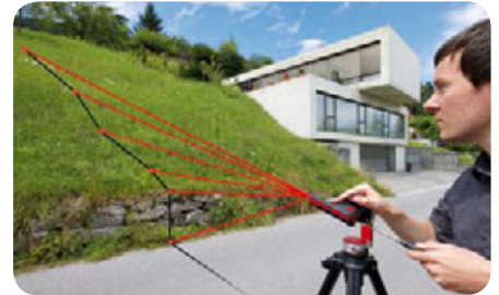
Mediciones de perfil de altura
