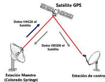
Figura 3 – Comunicación de datos entre estaciones y satélites
