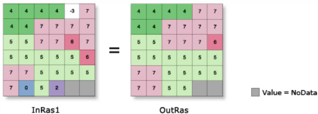
Imagen. Ilustrativa y simplificada de cómo opera un filtro, donde el Inras es la capa de entrada raster, y el OutRas el archivo de salida raster filtrado
