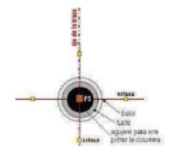
Cuando se trata de una estructura metálica, en cada punto habrá que replantear dos ejes perpendiculares entre sì, materializando la base de fundación. Uno de los ejes en la dirección de la línea, el segundo eje perpendicular al mismo.
