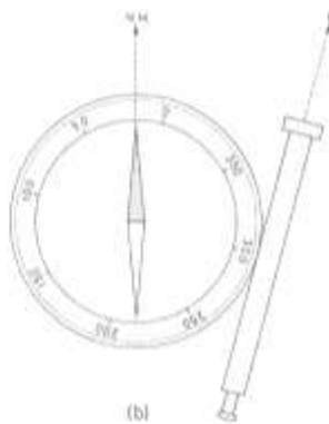
Fig. 10.5. — Lecturas de rumbos con brújula de limbo móvil.
