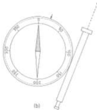
Fig. 10.6. — Lecturas de rumbos con brújula de limbo fijo.
