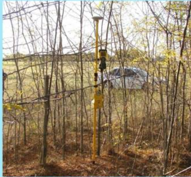
FOTOGRAFIA DEL SEGUNDO RECEPTOR (Rover) UBICADO SOBRE LA ESTACA QUE DELIMITA LA PARCELA, CONTRA EL ALAMBRADO DEL CAMINO AL SE, EN MODO ESTÁTICO – RAPIDO (el esquinero está hacia la derecha de la imagen)
