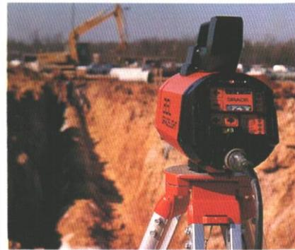
**Sobre el terreno.** Equipado con un asa con punto de mira y un trípode, el Gradelight es perfecto para estacionar sobre el terreno. El punto de mira, convenientemente integrado en el asa, posee un filtro rojo para una mejor visión del rayo. La base tangencial y soporte especial para planos muy inclinados son opcionales.
