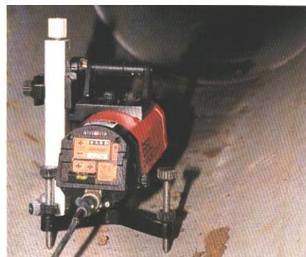
**Soporte de suelo.** Compacto y con tres puntos de apoyo regulables para hacer preajustes de nivel. Puede elegir entre una mira fija o de altura ajustable para facilitar el control de altura y alineación.
