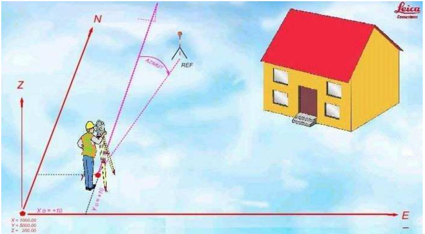
Una vez determinado el Azimut, se tiene que realizar la medición al primer punto (P1). Posteriormente se realiza la medición al segundo punto (P2)
