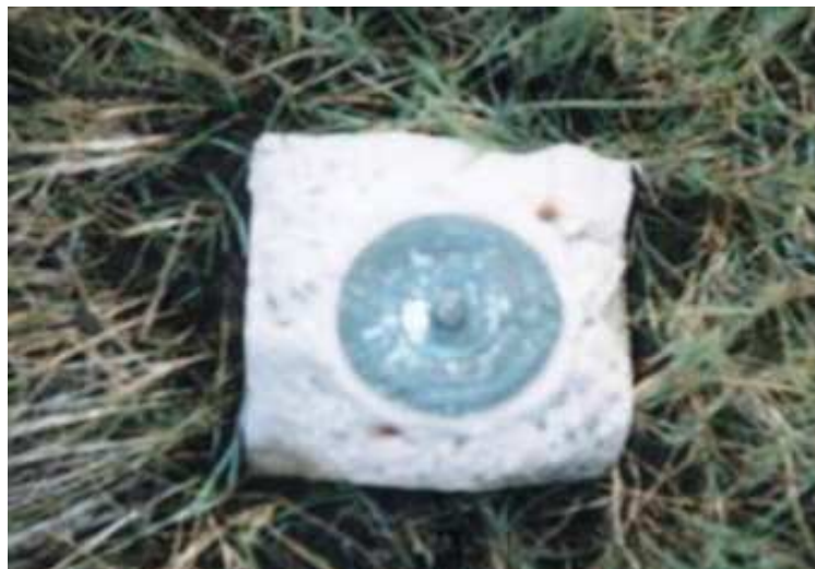
Punto Fijo de Nivelación PF 4 n (68) D
