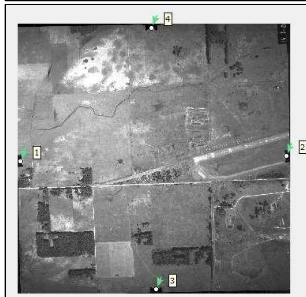
Imagen N°22 - Colocación de las marcas fiduciales
