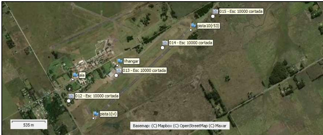
Imagen N°24 - Distribución de los puntos de control sobre la zona de trabajo que se utilizaron para realizar el primer modelo con Agisoft.
