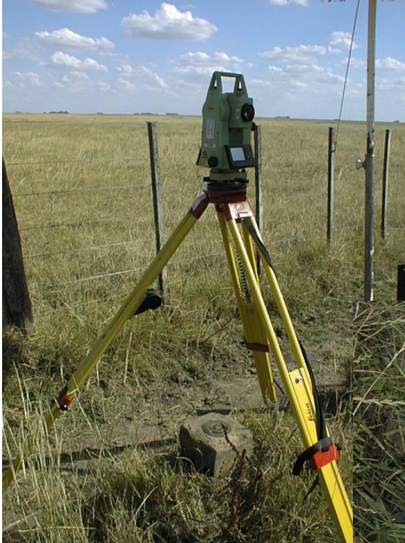
Estacion total en P.T.
