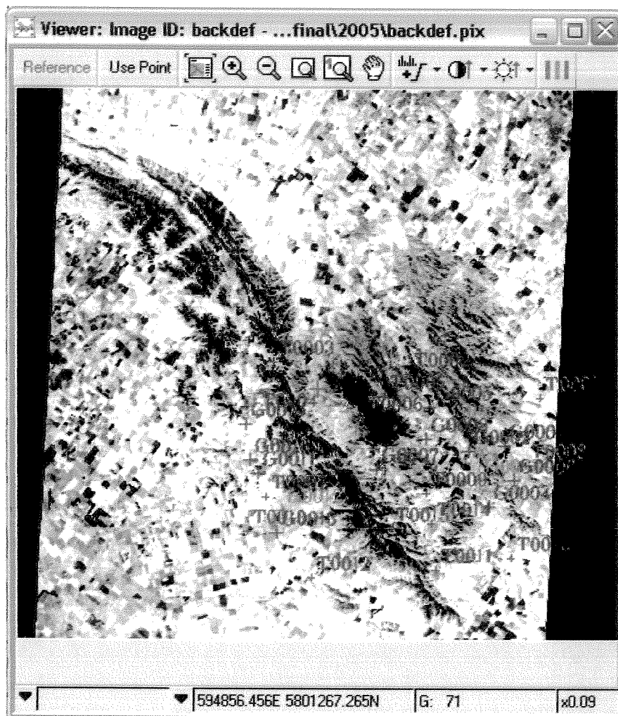
Fig. 37 Pantalla del programa Ortho Engine donde se observan los puntos de enlace (en azul), los puntos de control (rojo) y los puntos de chequeo (cyan), sobre la imagen “vista atrás”
